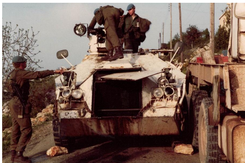
YP 408 nadat hij tegen een mortiertrekker met aangekoppelde 120 mm mortier was gebotst. Schade: 2 scharnieren van het motorluik en 120 mm mortier met een fikse deuk; terug naar Nederland voor revisie/ vervanging.
