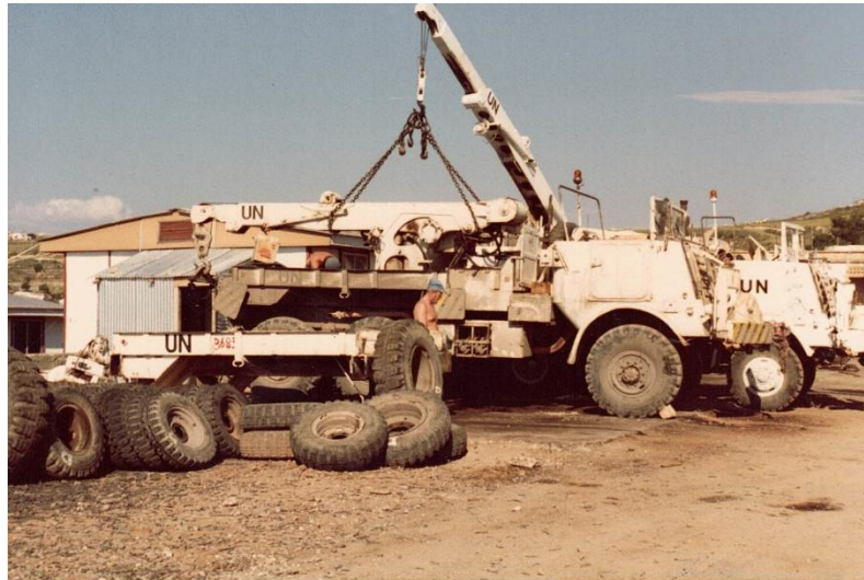
Bergingsmonteurs vervangen de opbouw van de YB 626
